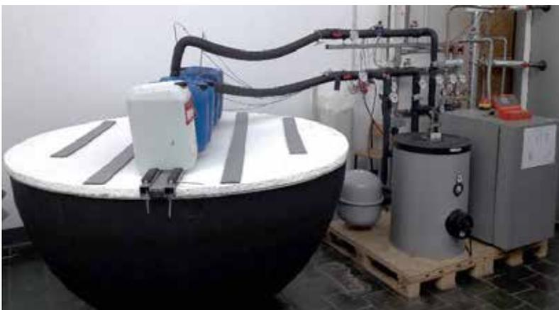
**Abb. 1: Eisspeichermodellprüfstand mit Eisspeicherhalbkugel (links), Regenerationswärmespeicher (Mitte) und Wärmepumpe (rechts)**
